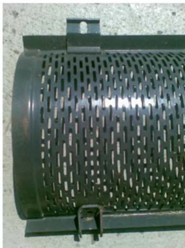
Abb. 2.4: Einsatz eines Speziessiebes in die Querförderschnecke des Mähdreschers (Claas-Kornmulde gelocht)
